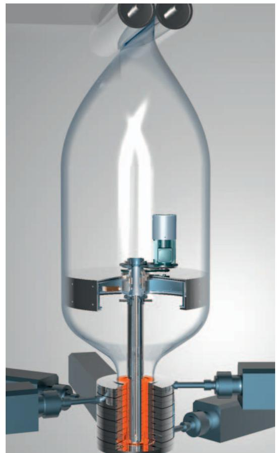
**Bild 4. Kalibrierkühlring mit geschlossenem Schlauch**
