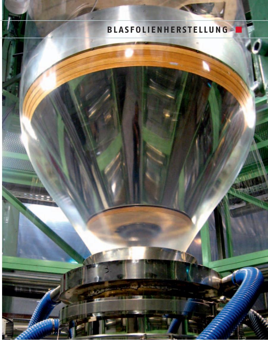
**Kühltechnik.** Durch die besonders intensive Kühlwirkung eines Kühl-Kalibrierkegels im Innern des Folienschlauchs kann die Bahngeschwindigkeit und damit die Produktivität der Blasfolienherstellung deutlich gesteigert werden. Die Öffnung des Folienschlauchs ermöglicht niedrigere Abzugserüste.
